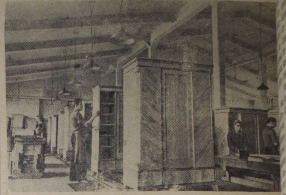
Ленинград. Коллектив мебельной фабрики № 3 ежемесячно пускает свыше двух тысяч платяных шкафов. Для их производства организован конвейер, с которого каждые 10 минут выходит готовый шкаф.
