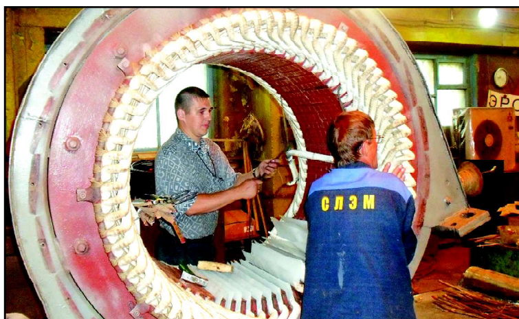
Ремонт электродвигателя 6 кВ мощностью 1,6 МВт занимается бригадир И.Н.Голубев.
